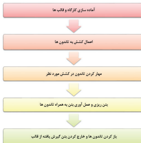
شکل ۱۲: مراحل تولید پایه های پیش تنیده
