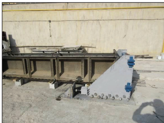
شکل ۱۶: سکوی تولید پایه بتنی پیش تنیده (قسمت متحرک)
