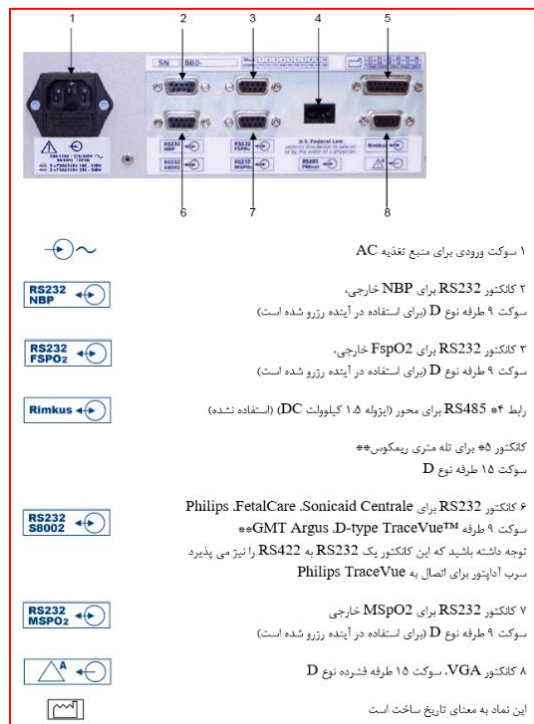
شکل (۲) نمای پنل پشتی Sonicaid FM800
