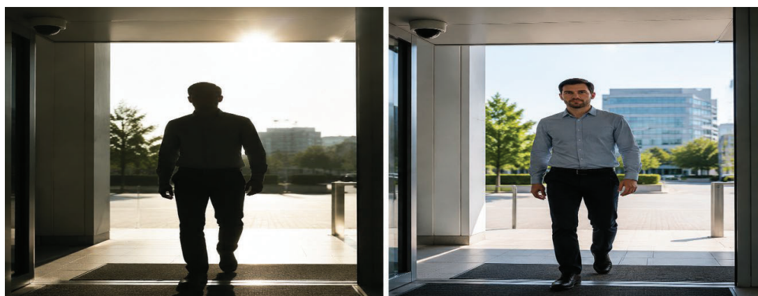
شکل ۳: مقایسه دوربین‌های دارای WDR با دوربین‌های معمولی
