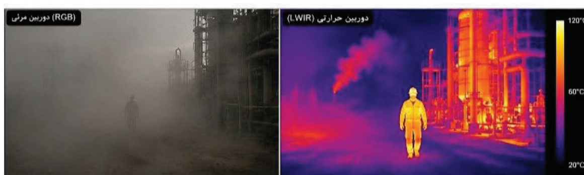
شکل ۱. مقایسه عملکرد دوربین مرئی و دوربین حرارتی در محیط دارای دود و مه
