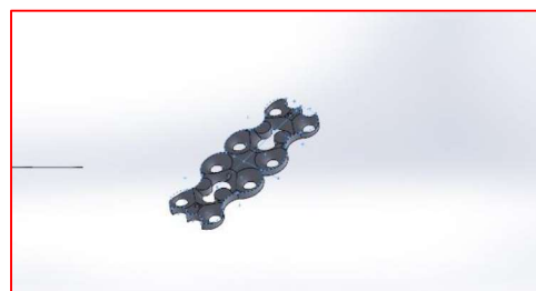
شکل ۱۲- یکسان‌سازی لبه‌های حفره‌ها به کمک ابزار convert
